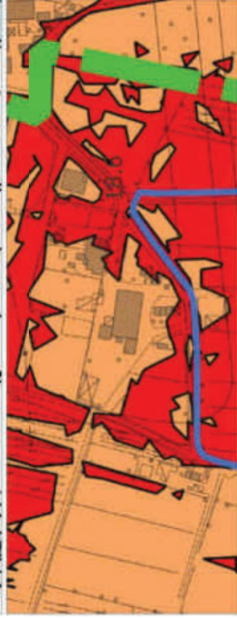
Estratto Piano Strutturale Carta della Pericolosità Idraulica A: Pericolosità idraulica elevata (I.3) B: Pericolosità idraulica elevata (I.3) in parte molto elevata (I.4) C: Pericolosità idraulica elevata (I.3)
